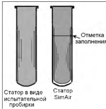
**Рисунок 2 – Схематическое изображение двух видов статоров**
